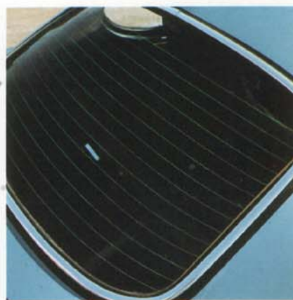
Bakrutan är eluppvärmad. För att alltid ge klar sikt bakåt. Fri från imma.
