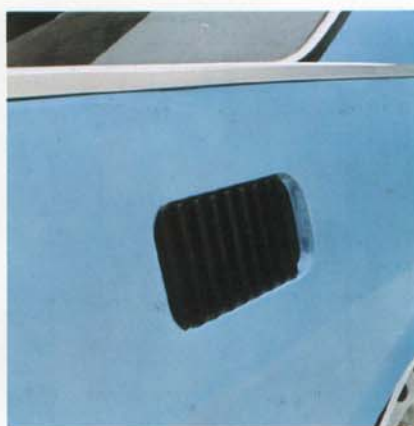
Genomluftningssystemet ger behaglig luftväxling i kupén. Utan drag. Backventilen hindrar avgaser att tränga in bakvägen.
