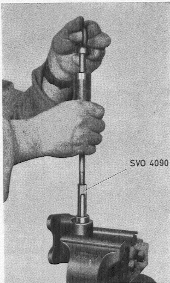
Abb. 62 Ausbau der Nadellager
