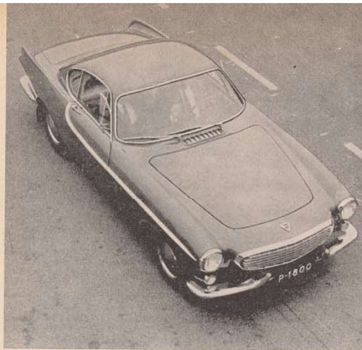
Volvo's Coupé is 42 cm breder dan hoog. Zoals bij meer en meer carrosserieën in deze stijl is de motorkap niet anders dan een bijna vlak deksel in de bovenzijde van de voorsteven. Er achter, vlak voor de voorruit, de inlaat van de luchtversings- en verwarmingsinstallatie.
