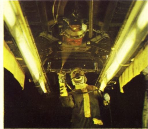
Der Volvo 1800S wird schon im Werk unterbodenschutzbehandelt.
