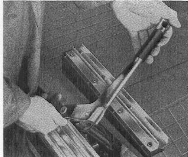
Abb. 48 Handbremshebel ausbauen, P 120
