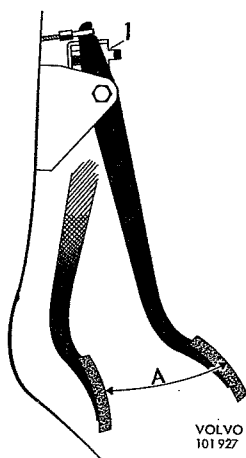
Fig. 4-4. Het afstellen van de slag van het koppelingspedaal
