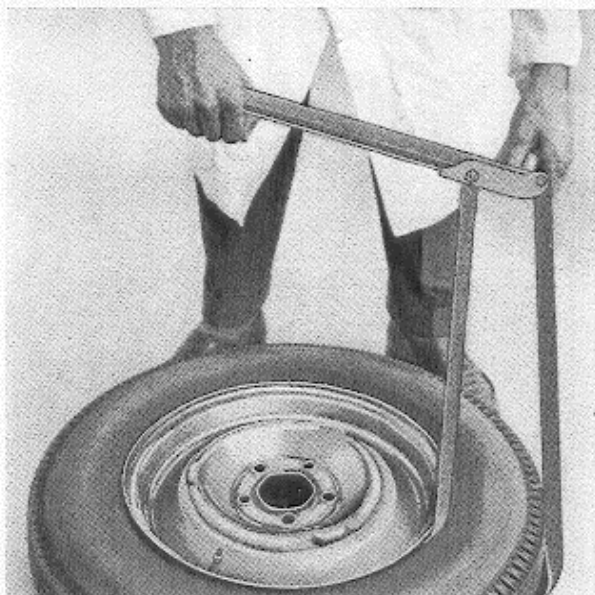
Fig. 25. Removing the tyre.
