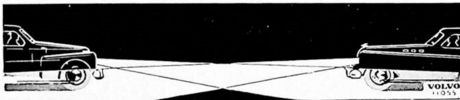
Korrekt afgestelde koplampen.
