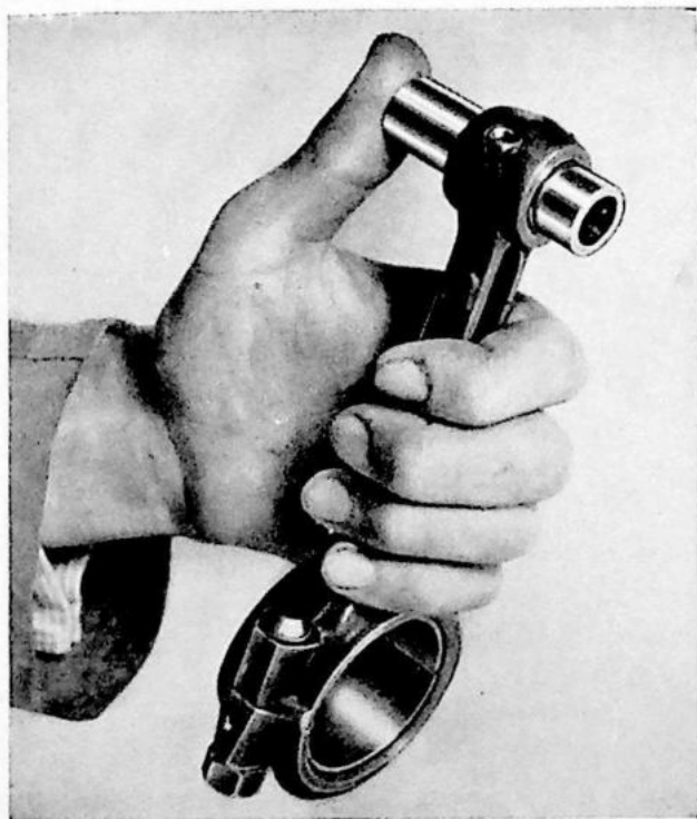
Fig. 45. Piston pin fit.
