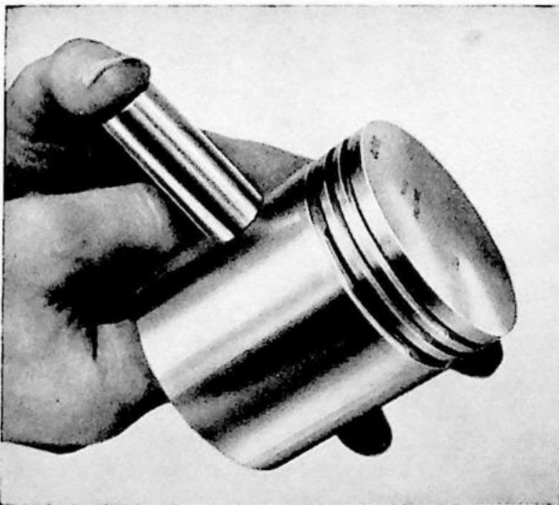
Fig. 38. Checking piston pin fit.
