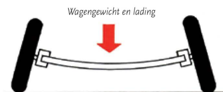
Doorbuiging van de as door wagen- en laadgewicht
